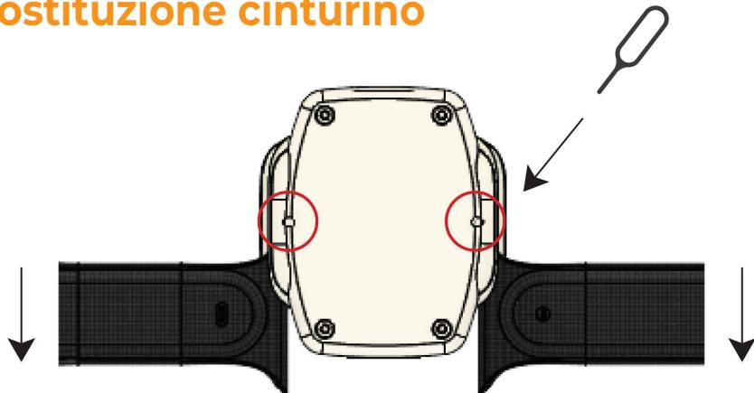
Per estrarre il cinturino del **NeosHelp**, basterà inserire l'estrattore per SIM nei due fori indicati nell'immagine. Facendo scorrere il cinturino verso il basso, sarà possibile rimuoverlo.
